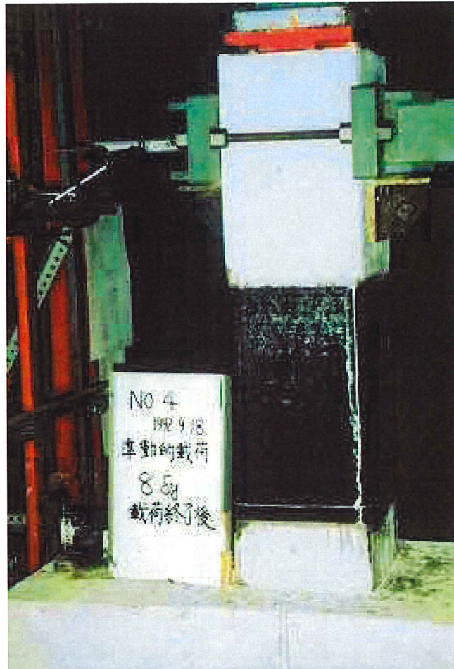
鉄筋コンクリート橋脚の耐震性向上確認試験
