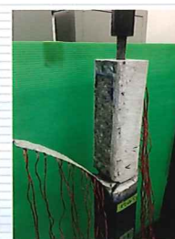
正常なコンクリート破壊
