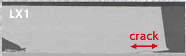
熱サイクルによる亀裂を大幅に抑制
