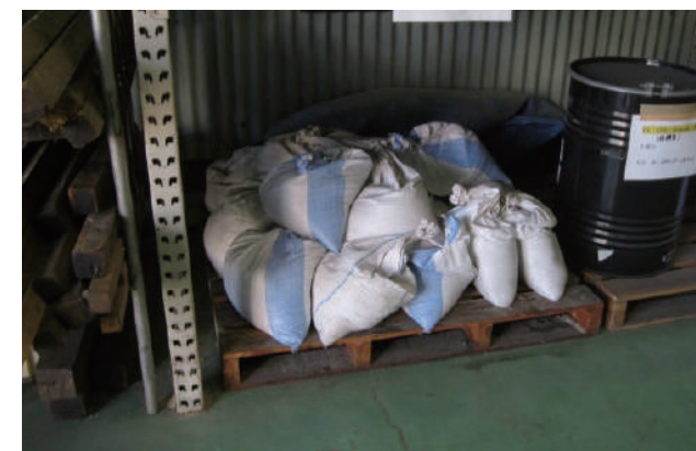
土のう保管状況
